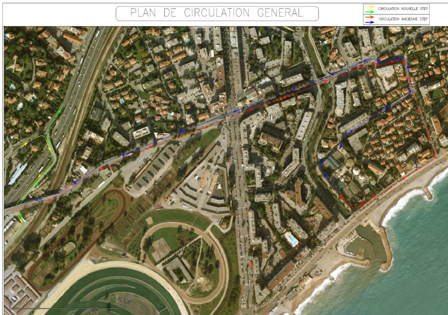
Figure 54 : Plan de circulation général pendant la phase travaux
