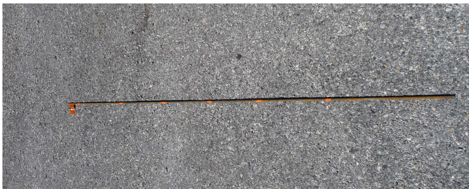
Pige de 3m en acier diam 8mm repérée par une étiquette et marquée tous les 50cm.
