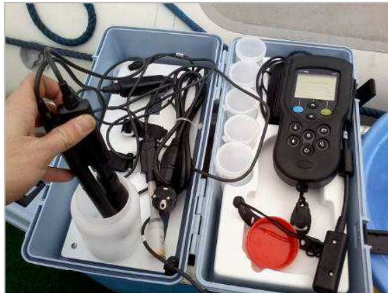
Photo 2 : Mesures des paramètres in situ , (sonde multi-paramètres)
